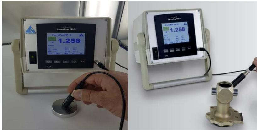
使用 List-Magnetik Ferropro FP-5 系列实验室设备,可以在 1.000 至 5.000 之间确定材料和构造零件的相对磁渗透率  $\mu_r$ , Ferropro FP-5 系列可以统计评估测量值,并通过 USB 与 Windows PC 连接通讯。
